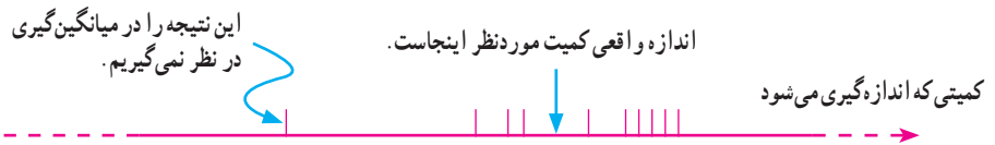
شکل ۱-۱۰ نتایج اندازه‌گیری شده حول اندازه واقعی. هر نشانه قرمز رنگ، نشان‌دهنده نتیجه یک اندازه‌گیری است.
