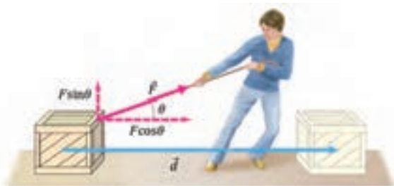
شکل ۳-۲ نیروی ثابت \vec{F} با جابه‌جایی \vec{d} زاویه \theta می‌سازد و کار W = (F \cos \theta) d را روی جسم انجام می‌دهد.
