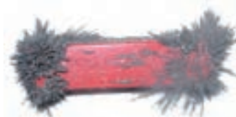
شکل ۳-۳ در آهنربا، دو ناحیه وجود دارد که خاصیت مغناطیسی در آنجا بسیار بیشتر از قسمت‌های دیگر است.
