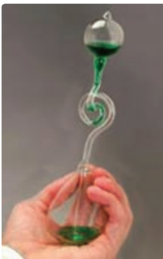
شکل ۴-۴۲ با در دست گرفتن حباب شیشه‌ای و گرم کردن آن، مایع رنگی در لوله مارپیج بالا می‌رود.
