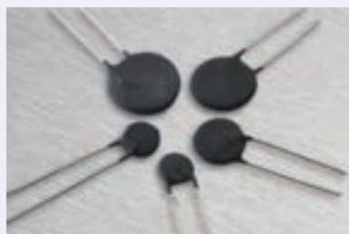
(ب) تصویری از چند ترمیستور دیسکی واقعی
