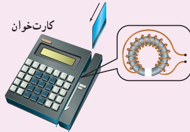
(ب) کشیدن کارت، جریان اندکی در پیچه دستگاه کارت خوان القا می‌کند.
