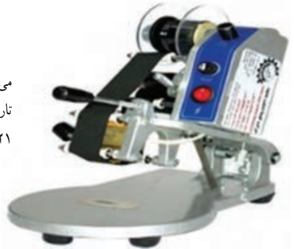
شکل ۲۱-۱۱- دستگاه برچسب‌زنی حبوبات
