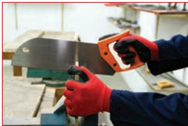
الف- برش دادن شیار
