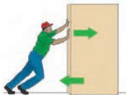
شکل ۲- شخص به جعبه ساکن نیرو وارد می‌کند ولی جعبه حرکت نمی‌کند زیرا نیروی روبرو به جلو با نیروی اصطکاک رو به عقب هم‌اندازه‌اند.
