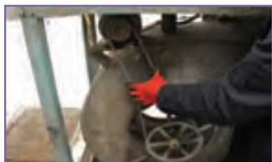
پ- بررسی وضعیت تسمه
