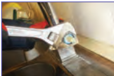
ث- باز کردن پیچ روی مغزی (گلند)
