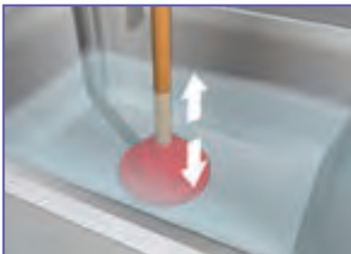
ب – حرکت عمودی لوله بازکن
