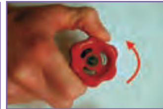
ح - باز کردن شیر فلکه اصلی
