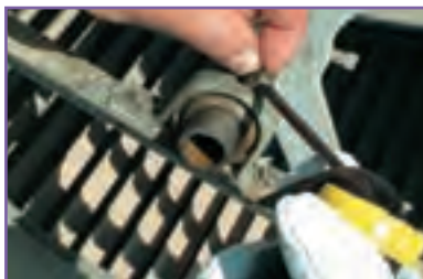
ث- روغن‌کاری یاتاقان‌ها
