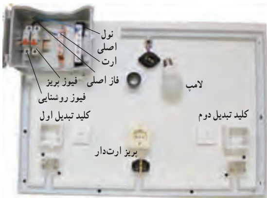
شکل ۲۰-۵- سیم‌کشی کلیدهای تبدیل
