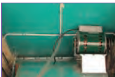
ح - آزمایش صحت مدار آب پخش کن
