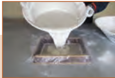
ث - ریختن ملات گچ در قالب
