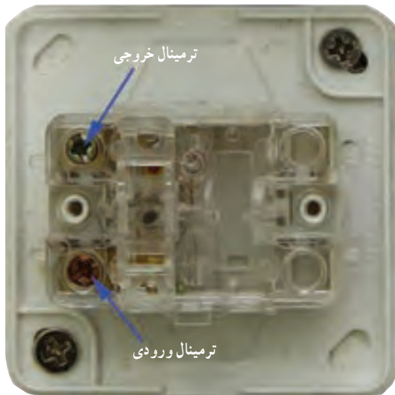
شکل ۴-۵- نمای داخلی یک نمونه کلید یک پل
