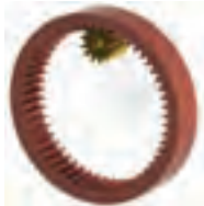
ج- ساز و کار حرکتی چرخ دنده داخلی
