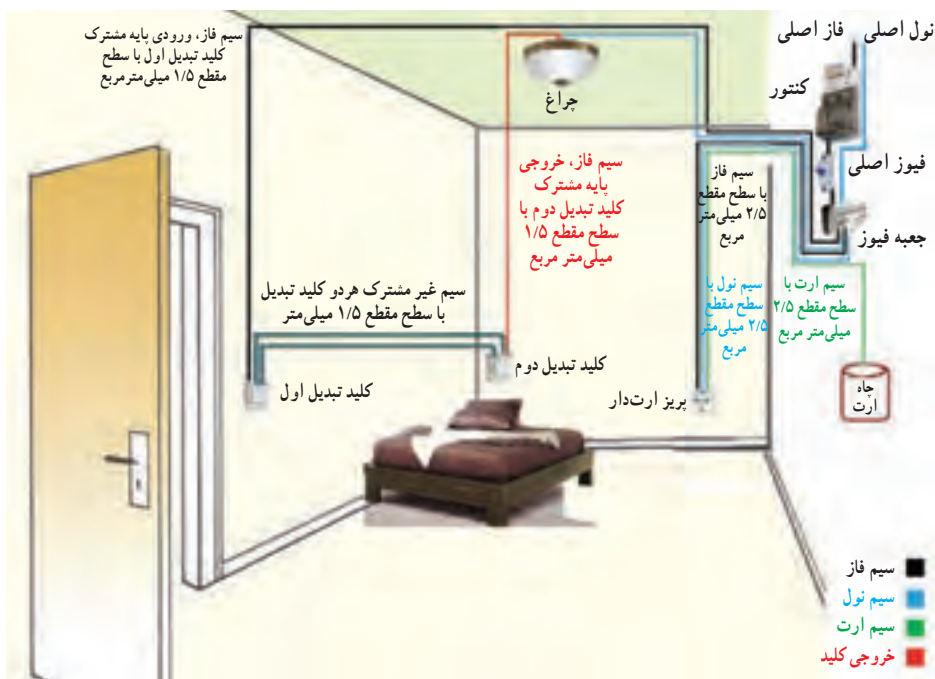
شکل ۱۸-۵ - سیم‌کشی مدار کلید تبدیل
