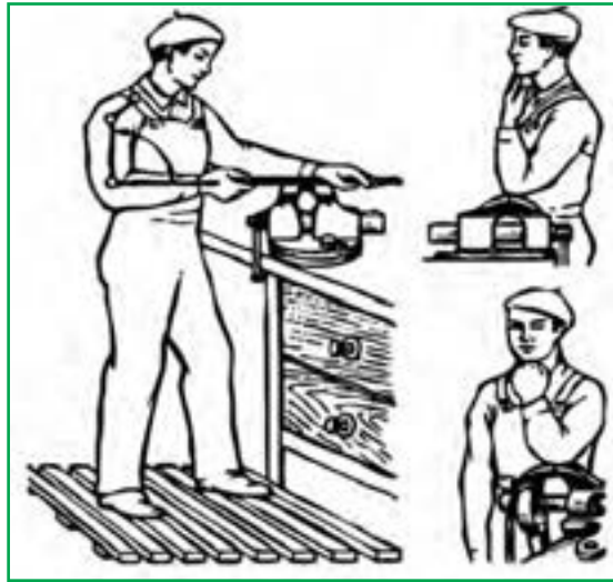
شکل ۱۶-۱- روش صحیح ایستادن و ارتفاع مناسب گیره
