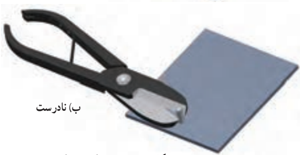
شکل ۱-۸- روش استفاده از قیچی
