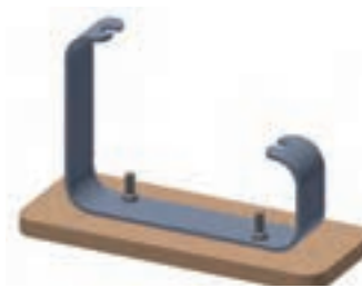
شکل ۳۹-۱- متصل کردن قطعات با پیچ و مهره شکل ۴۰-۱- قرار گرفتن گل پیچ با قطر ۸ میلی‌متر شکل ۴۱-۱- قرار گرفتن شیشه‌ها در شیارهای قاب عکس
