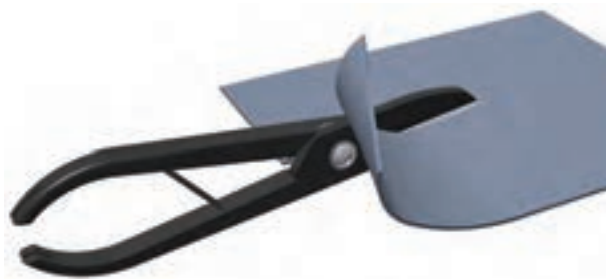
شکل ۱-۶- قیچی کاری ورق
