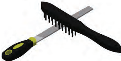
شکل ۱۷-۱- تمیز کردن سوهان با برس سیمی
