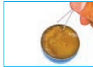
ب - آغشته کردن پایه ها به روغن لحیم
