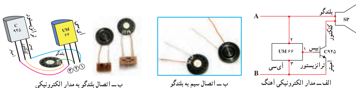
شکل ۲-۲۶ - مدار الکترونیکی جعبه آهنگ
