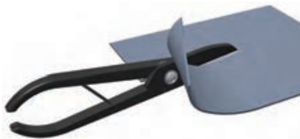
شکل ۱-۶- قیچی کاری ورق
