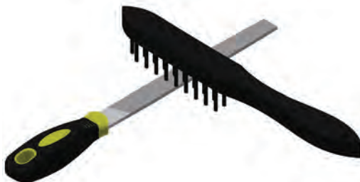
شکل ۱۷-۱- تمیز کردن سوهان با برس سیمی
