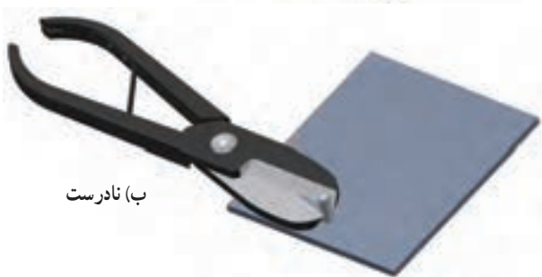
شکل ۱-۸- روش استفاده از قیچی
