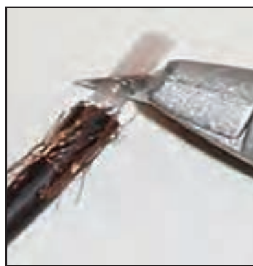
۴- عایق زیر را نیز روکش برداری کنید
