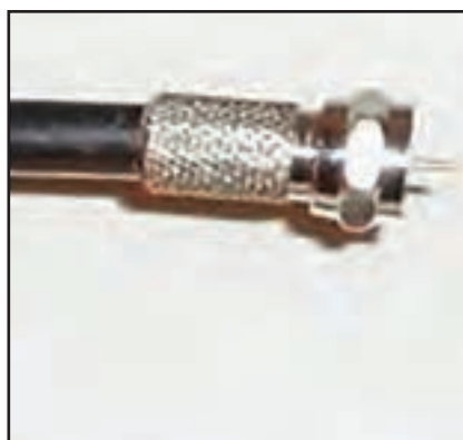
۸- صحت اتصال انجام شده را توسط یک اهم متر بررسی کنید. صحت اتصال شبیه فعالیت یک است.
