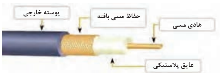
شکل ۳- اجزای کابل کواکسیال
