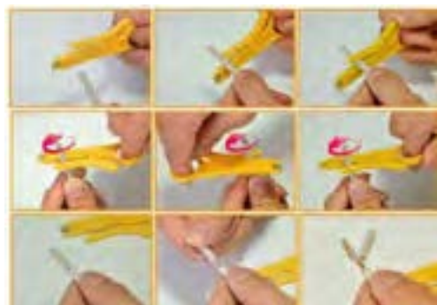
شکل ۷- روکش برداری کابل
