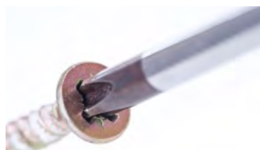
الف) استفاده صحیح از آچار پیچ گوشتی
