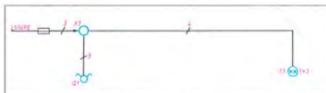
شکل ۳۰ - ۳- شمای فنی مدار کلید دویل
