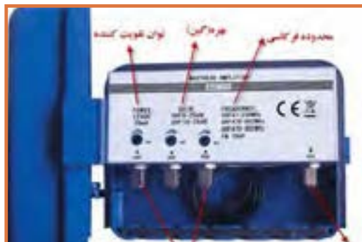
شکل ۱۵- مشخصات فنی یک بوستر یا تقویت کننده
