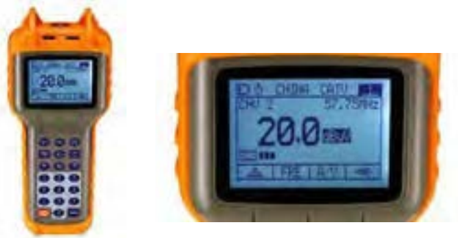
شکل ۲۴- اندازه‌گیری سیگنال خروجی آنتن توسط سیگنال سنج
