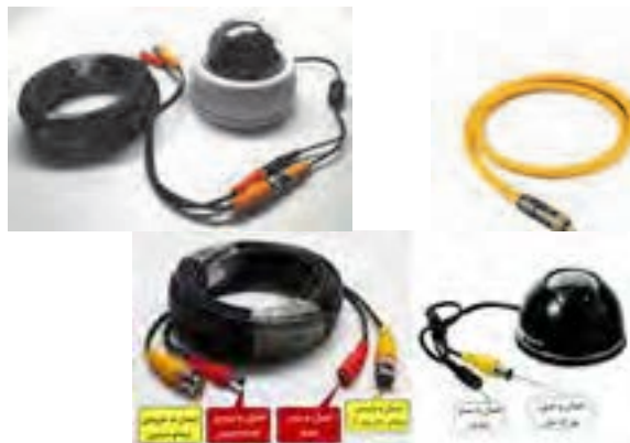
شکل ۲۴ - اتصالات دوربین و مبدل های AV به BNC
