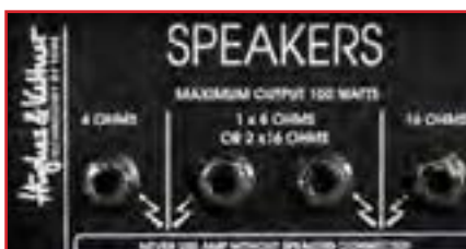
شکل ۲۰- امپدانس خروجی بلندگو
