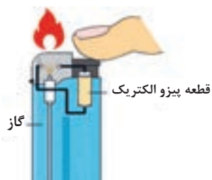
شکل ۱۱ (ج) - کاربرد پیزوالکتریک در فندک
