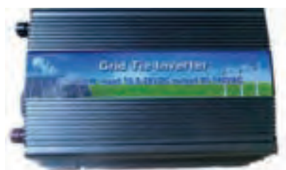
شکل ۴۱- اینورتر متصل به شبکه برق
