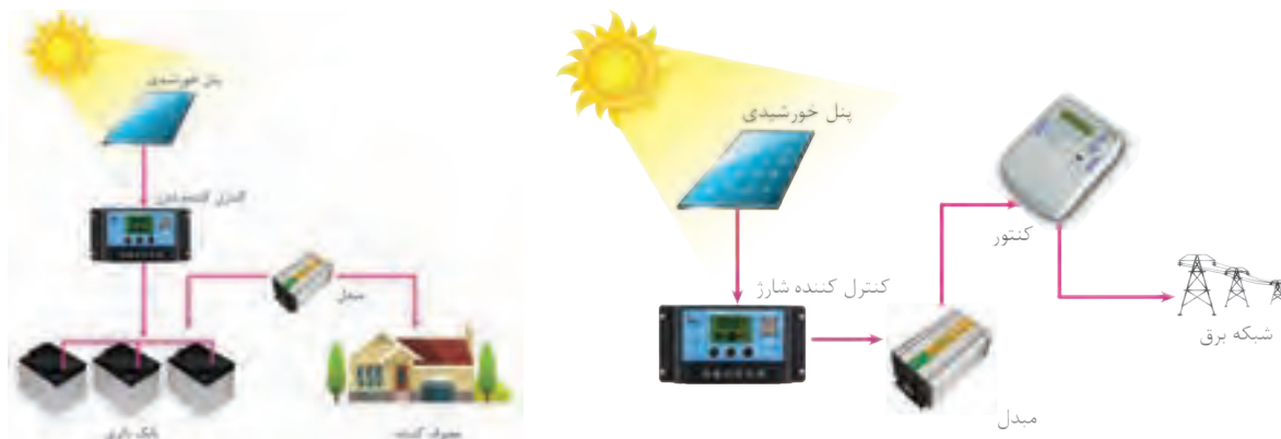
ب- سامانه فتوولتاییک مستقل از شبکه
