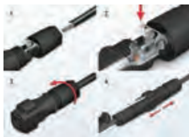
شکل ۴۵- مراحل اتصال کانکتور MC۴
