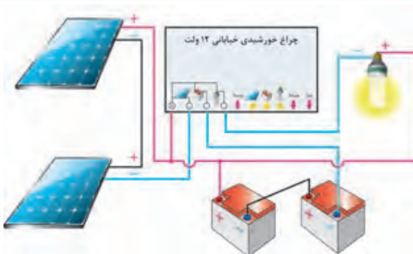
شکل ۵۲- چراغ خورشیدی خیابانی ۲۴۷ طراحی اتصال کابل
