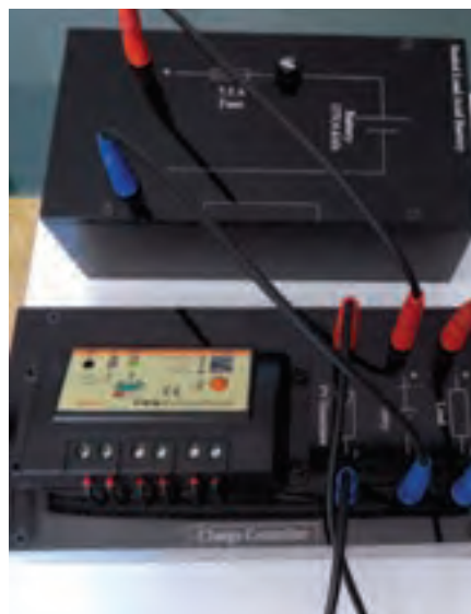
شکل ۲-۳۷ و ۱-۳۷ اتصال کنترل شارژ به مدول
