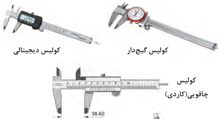
شکل ۱۲- انواع کولیس ها
