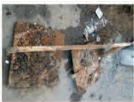
شکل ۲۵- خوردگی در اتصالات
