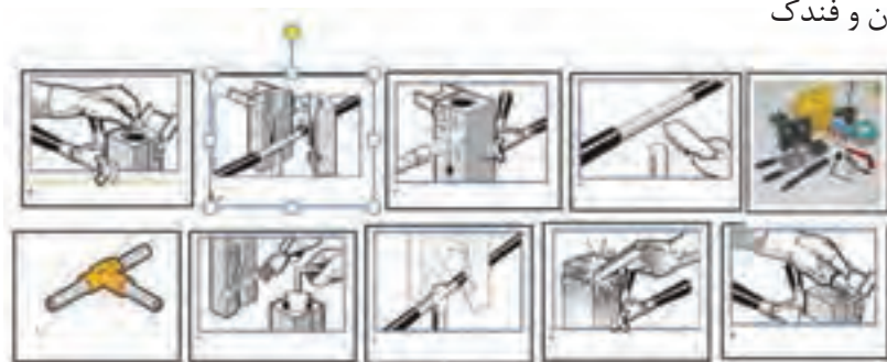
شکل ۱۳- وسایل و مراحل جوش احتراقی سیم مسی
