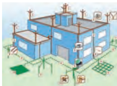
شکل ۳۸ - پراکنده کردن صاعقه در زمین
