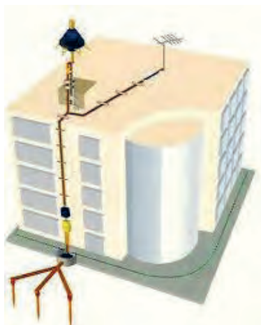
شکل ۴۲- میله صاعقه گیر
