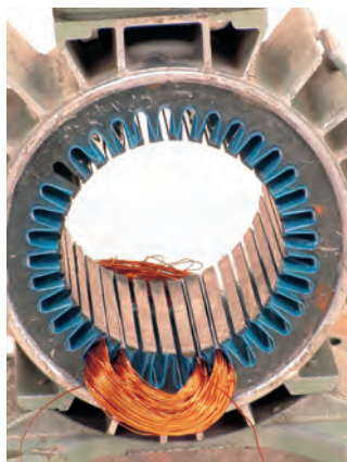
شکل ۶۷- قرار گرفتن اولین گروه کلاف در شیارهای استاتور
