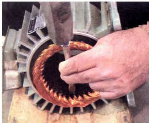
شکل ۲۱- بریدن سیم‌ها توسط قلم
