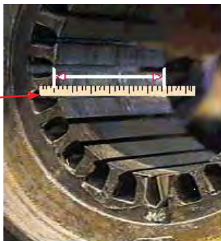
شکل ۲۷- اندازه گیری طول و قطر داخلی استاتور
