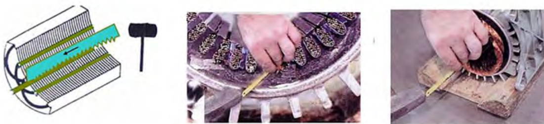
شکل ۲۳- خارج کردن پرسیان از شیار
