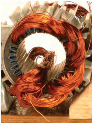
شکل ۷۰- در آوردن بازوهای ۱،۲،۳ برای قرار دادن کلاف آخر
