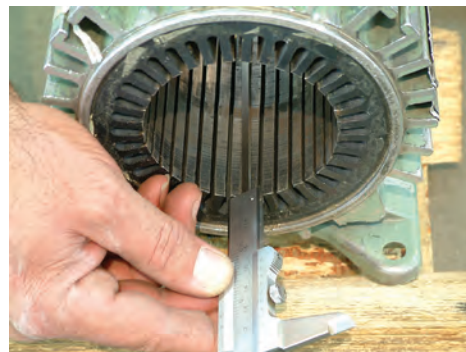
شکل ۲۷- اندازه گیری طول و قطر داخلی استاتور
