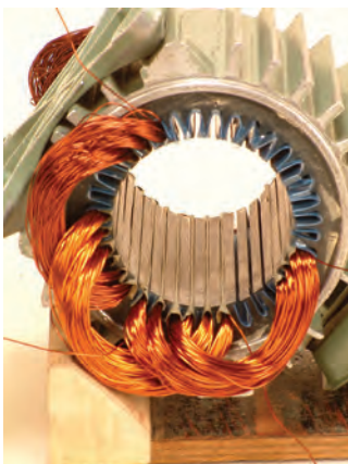
شکل ۶۹- قرار گرفتن سومین گروه کلاف در شیارها
