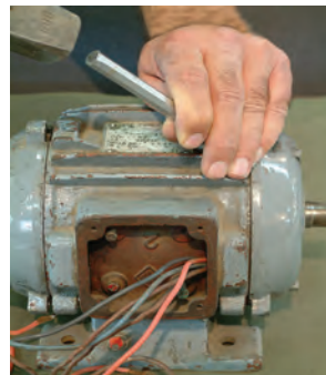
شکل ۱۸- باز کردن پیچ‌های موتور و درپوش‌ها
