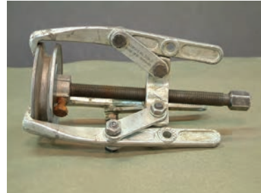
شکل ۱۷- در آوردن پولی از محور موتور
