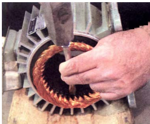
شکل ۲۱- بریدن سیم‌ها توسط قلم
