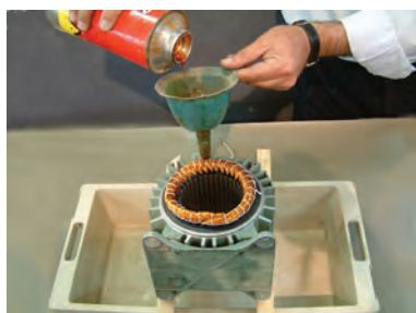
شکل ۶۱- شارلاک زدن سیم پیچی استاتور
