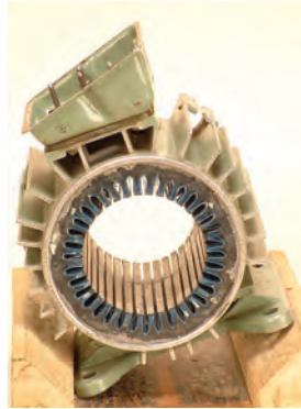
۲۹-۲- استاتور عایق کاری شده
