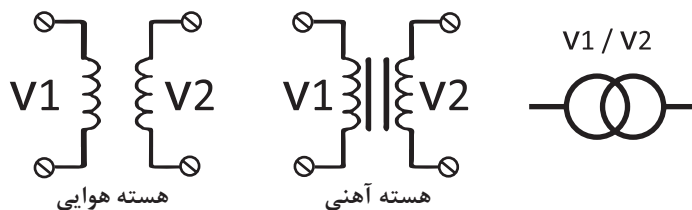
شکل ۳- علائم اختصاری ترانسفورماتور با هسته های مختلف
