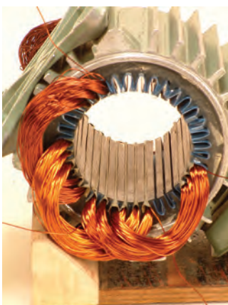
شکل ۶۹- قرار گرفتن سومین گروه کلاف در شیارها
