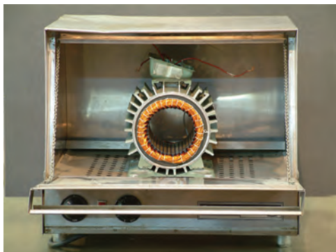
شکل ۲۲- گرم کردن سیم پیچ
