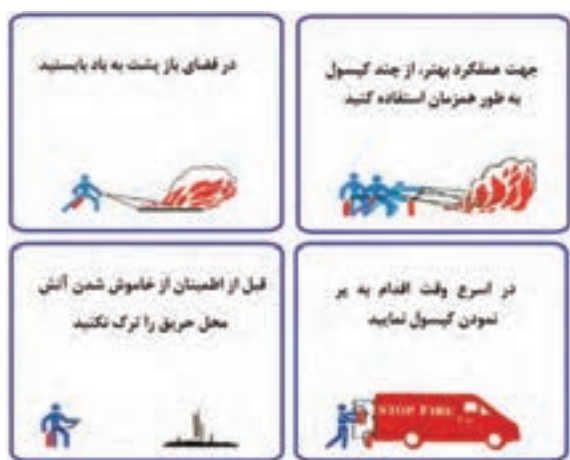
شکل ۱۷-۲ نکات مهم در به کارگیری خاموش کننده‌های دستی
