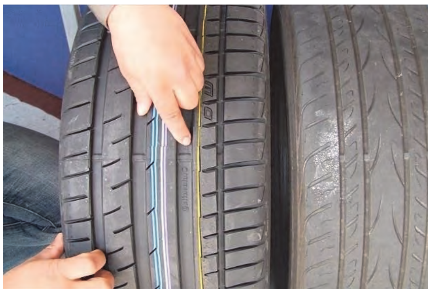
شکل ۱۳- فرسایش لاستیک‌ها بر اثر وزن غیرمجاز بار
