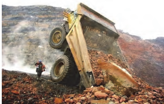
شکل ۱۰- واژگونی کامیون به دلیل بار زیاد
