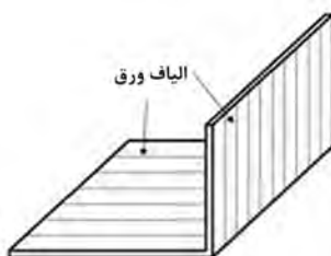
شکل ۲۹-۱- جهت الیاف ورق
