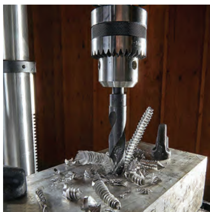
شکل ۳۰-۳- عملیات سوراخ کاری قبل از برقوکاری
