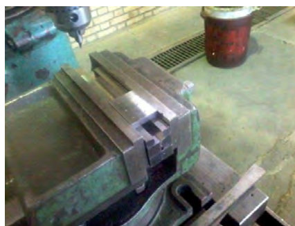
شکل ۴-۱۸- بستن قطعه کار
