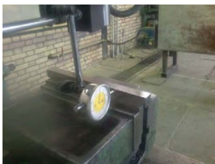
شکل ۴-۱۹- تنظیم و بستن گیره روی میز دریل
