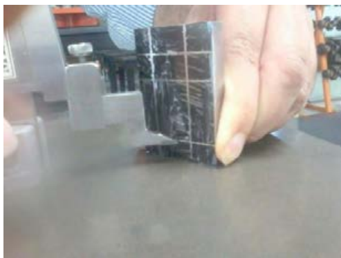
شکل ۴-۱۷- انتقال مشخصات نقشه کار روی قطعه کار
