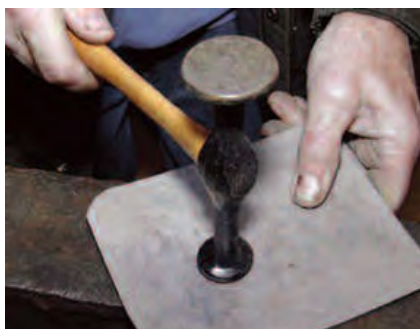
شکل ۲۸-۱- خم کاری روی سندان
