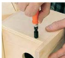
شکل ۲۷-۴ خزینه کاری دستی
