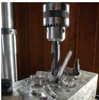
شکل ۳۰-۳- عملیات سوراخ کاری قبل از برقوکاری
