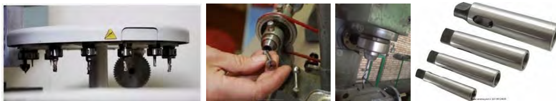
شکل ۴-۲- کاربرد سوراخ مخروطی در دستگاه‌های فرز
