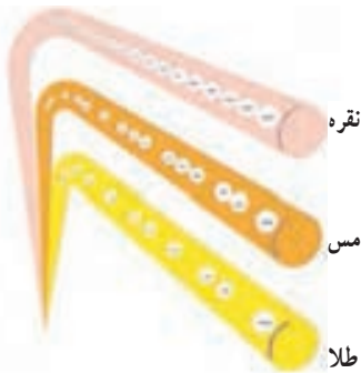
شکل ۱۸-۱- مقایسه الکترون‌های آزاد در هادی‌های خوب
