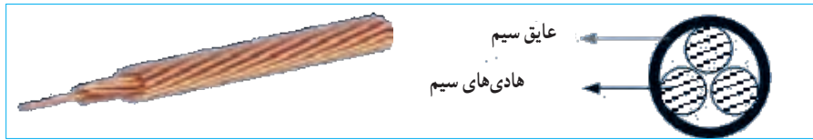
شکل ۱۱-۲- سطح مقطع سیم نیمه افشان
