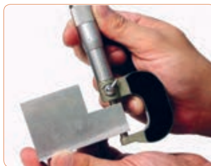
شکل ۱۶-۲ چگونگی در دست گرفتن میکرومتر
