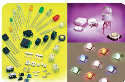
شکل ۱۳-۳۳ – چند نمونه LED
