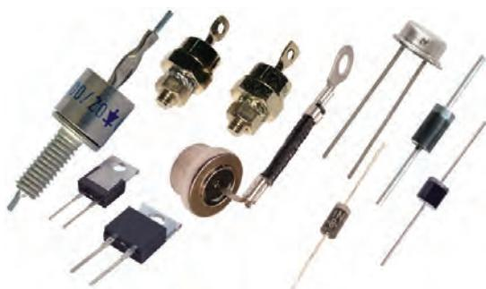
شکل ۱۳-۲۴-چند نمونه دیود یکسوکننده معمولی
