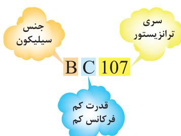
شکل ۱۴-۳۱—مشخصات ترانزیستور ۷BC107
