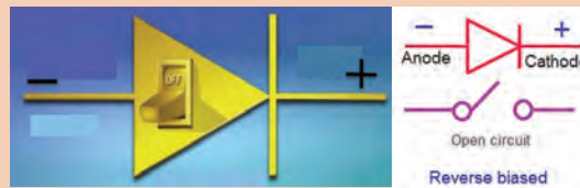
شکل ب ۳-۸- دیود ایده‌آل در بایاس مخالف
