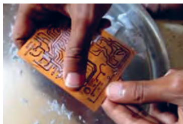
شکل ۱۱-۷- جدا کردن کاغذ از سطح روی فیبر
