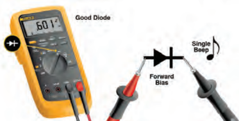
شکل ۳-۶- وضعیت تست دیود در بایاس موافق
