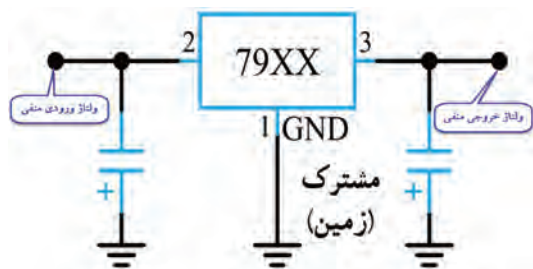
شکل ۳-۷۶- مدار استاندارد قرارگرفتن آی سی
