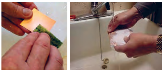
شکل ۱۹-۵- شستشو و تمیز کردن فیبر مدار چاپی
