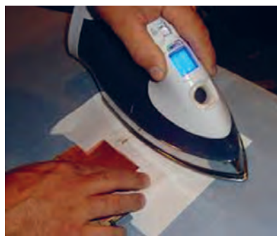
شکل ۹-۷- کشیدن اتو روی کاغذ و فیبر
