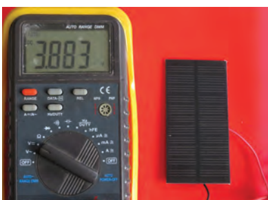
شکل ۳-۹۵- اندازه‌گیری ولتاژ سلول خورشیدی
