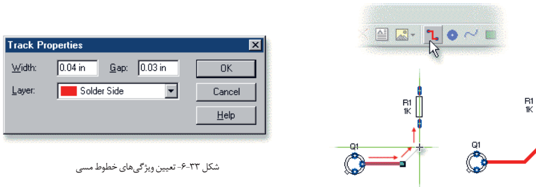
شکل ۶-۳۲- نحوه اتصال خطوط مسی بین پایه قطعات
