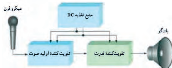
شکل ۴-۱۷- بلوک دیاگرام آمپلی فایر صوتی
