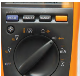
شکل ۳-۵- مولتی متر دیجیتالی در حالت آزمایش دیود
