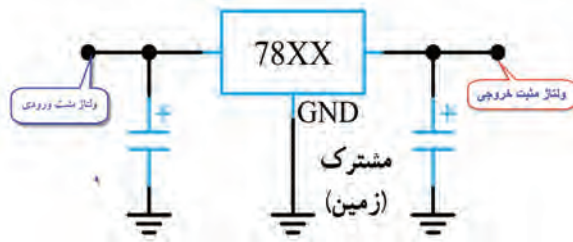
شکل ۷۱-۳- مدار استاندارد قرارگرفتن آی‌سی در مدار
