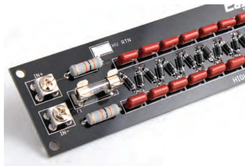
شکل ۳-۸۸- مدار چند برابر کننده ولتاژ با قطعات واقعی
