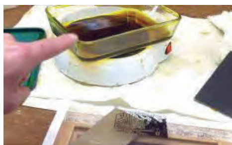
شکل ۱۵-۷- استفاده از اجاق برقی برای حرارت دادن محلول اسید کاری
