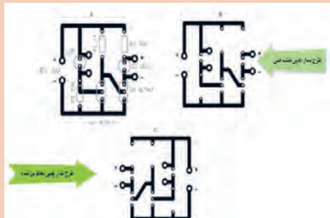
شکل ۱۵-۵- طرح مدار چاپی معکوس شده
