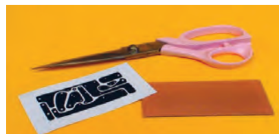
شکل ۷-۷- برش طرح مدار چاپی از کاغذ
