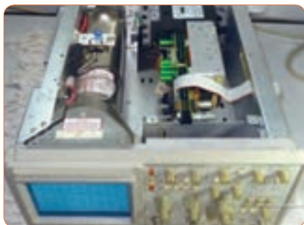
شکل ۴-۵۲- ساختمان داخلی یک نوع اسیلوسکوپ
