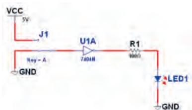
شکل ۵۹-۶- مدار گیت منطقی NOT
