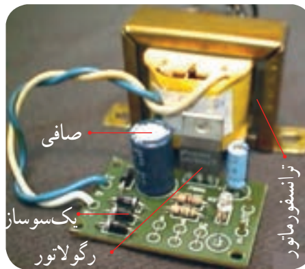
شکل ۶۵-۶ بلوک دیاگرام منبع تغذیه و مدار واقعی آن
