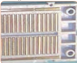
شکل ۸۹- ۱- اتصالات داخلی برد بُرد
