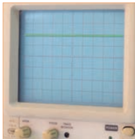
شکل ۷۴-۴ موج DC روی صفحه نمایش
