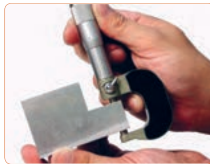
شکل ۱۶- ۲- چگونگی در دست گرفتن میکرومتر
