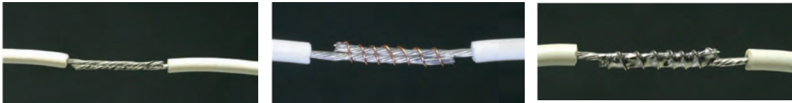
شکل ۶۰-۱- اجرای یک اتصال ساده
