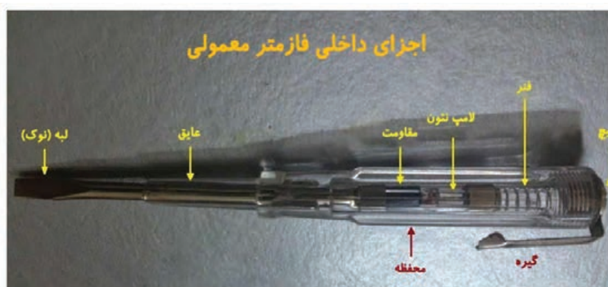
شکل ۲-۳۷- ساختمان داخلی فازمتر
