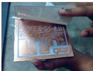
شکل ۱۱-۷- جدا کردن کاغذ از سطح روی فیبر
