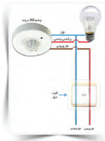
شکل ۲-۷۱- یک نمونه نقشه رله چشمی راه پله
