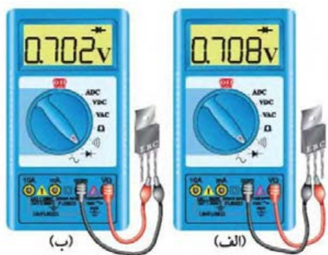
شکل ۴-۴- ولتاژ موافق کلکتور-بیس و امیتر-بیس
