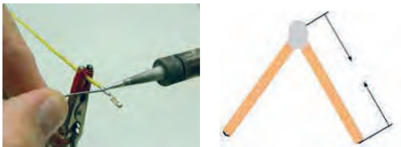
شکل ۱-۵۷- ساخت زاویه ۳۰ درجه
