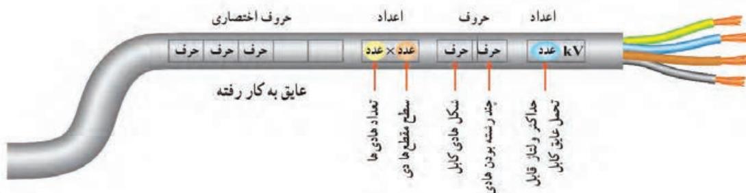
شکل ۲-۱ - مشخصات فنی یک نوع کابل
