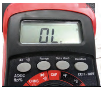
شکل ۳-۶- وضعیت تست دیود در بایاس موافق
