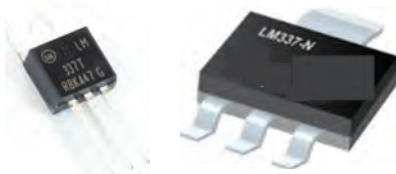
شکل ۸۱-۳- نقشه مدار و تصویر دو نمونه رگولاتور منفی
