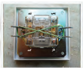
شکل ۲-۸۰ - ساختمان داخلی کلید کولر
