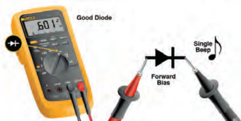
شکل ۳-۶- وضعیت تست دیود در بایاس موافق
