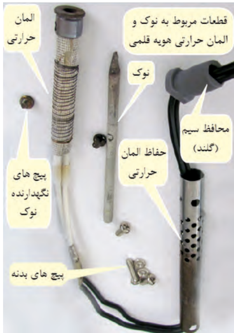
شکل ۹۵-۱ - مراقبت از اجزاء داخلی هویه قلمی
