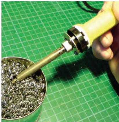
شکل ۴۲-۱- تمیز کردن نوک هویه با اسفنج مخصوص
