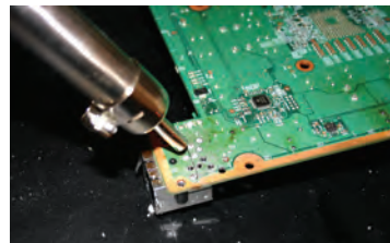
الف- شروع کار با استفاده از قلع کش
