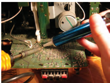
شکل ۸۴-۱- مراحل ذوب شدن و مکش قلع
