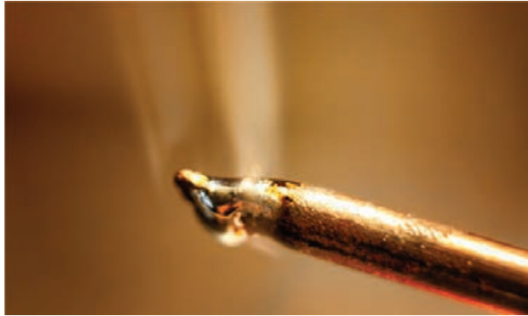
شکل ۴۱-۱- فرو بردن نوک هویه در روغن لحیم
