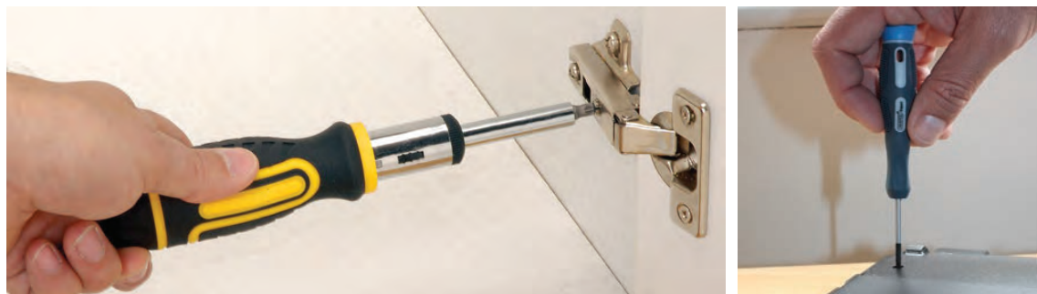
شکل ۳۱-۱- چگونه صحیح در دست گرفتن پیچ گوشتی
