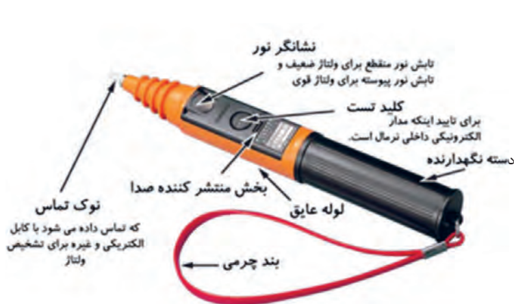
شکل ۳۸-۲- ساختمان داخلی فازمتر دیجیتالی
