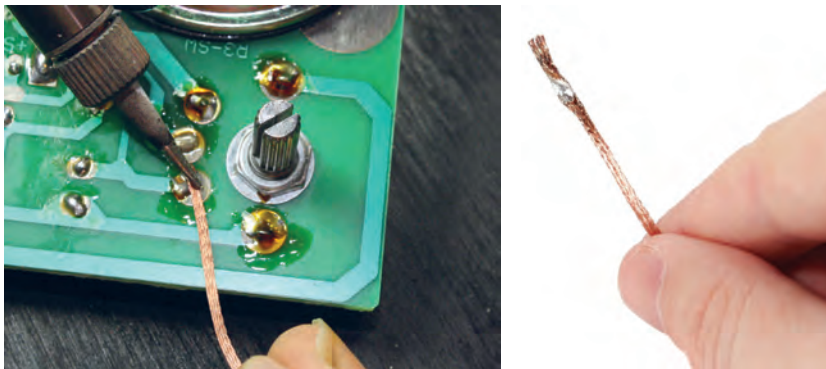
شکل ۸۰-۱- برداشتن قلع از روی فیبر
