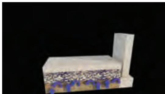
جلوگیری از صعود رطوبت به وسیله بلوک‌ها
