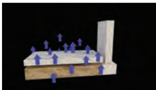
صعود رطوبت در اثر مویبندی در خاک و رسیدن رطوبت به کف فضا
