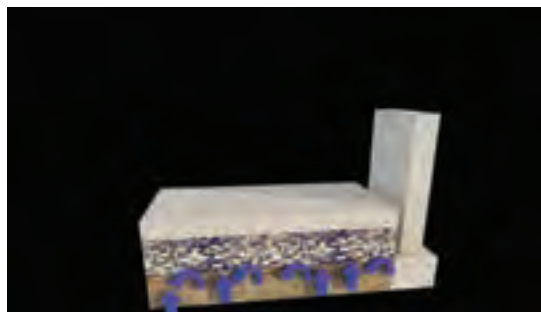
جلوگیری از صعود رطوبت به وسیله بلوکاز
