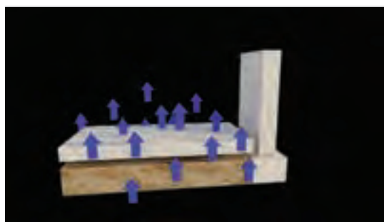
صعود رطوبت در اثر مویبینگی در خاک و رسیدن رطوبت به کف فضا
