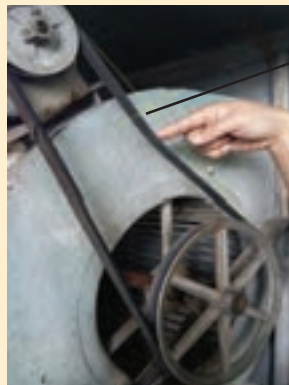
آزمایش سفتی تسمه
