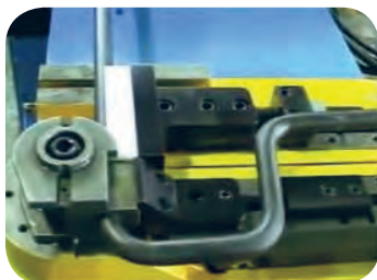
خم کاری لوله
