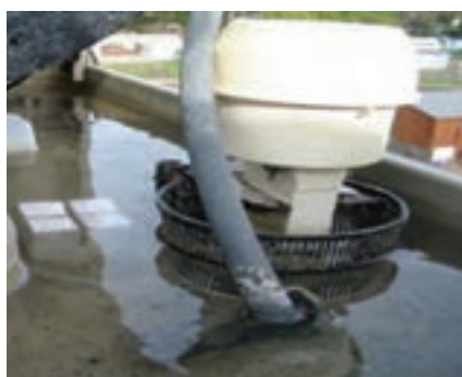
شیلنگ رابط پمپ و چهارراهی
