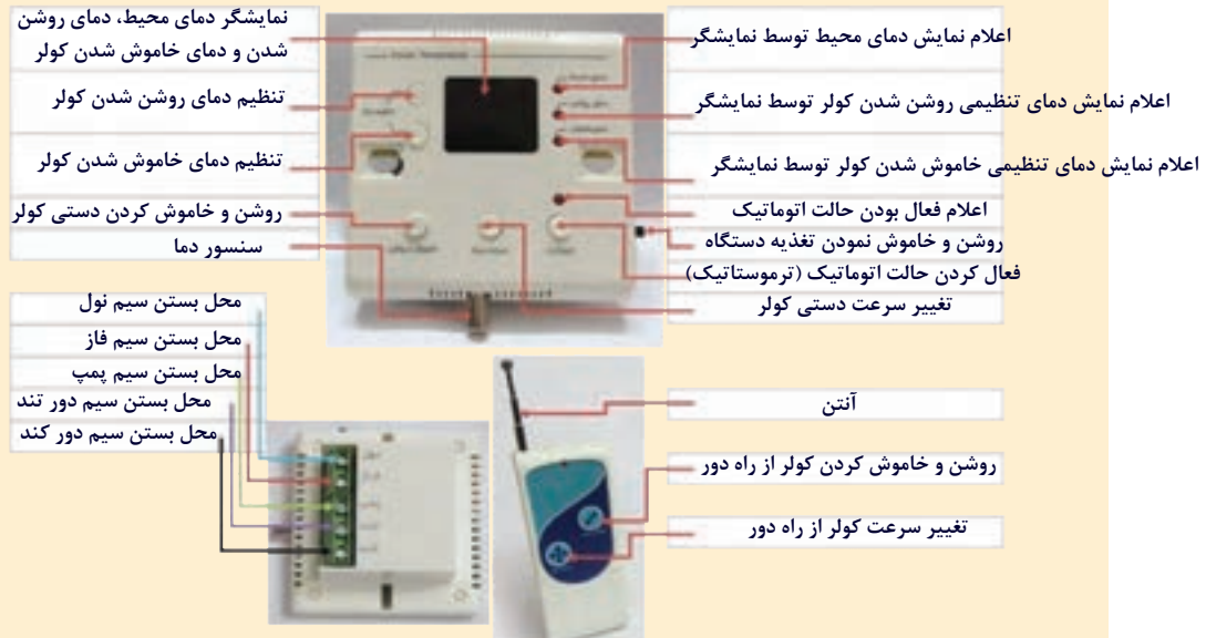
مدار کلید هوشمند کولر آبی
