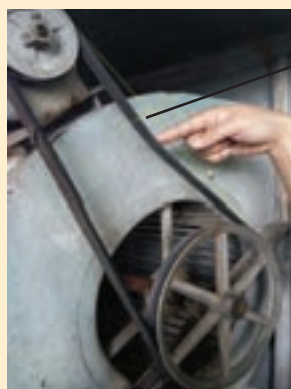
آزمایش سفتی تسمه
