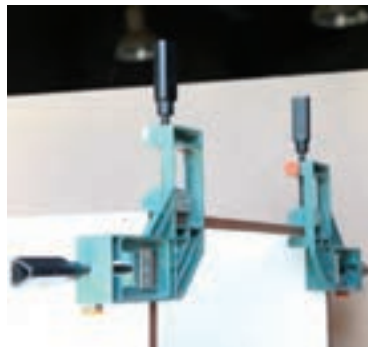
شکل ۵۲ - فیکس کردن قطعات
