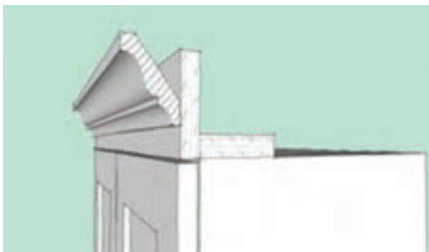
شکل ۳۵- روش نصب تاج در کابینت‌های چوبی
