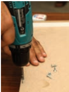
شکل ۵۶ - بستن کف جعبه با پیچ
