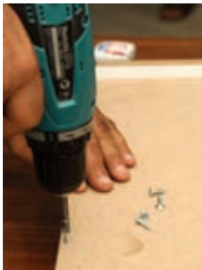
شکل ۵۶ - بستن کف جعبه با پیچ
