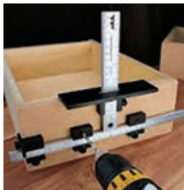
شکل ۱۳۴- چند نوع شابلون سوراخ کاری محل دستگیره
