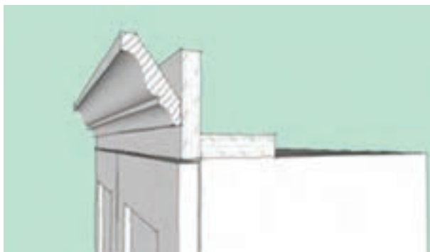
شکل ۳۵- روش نصب تاج در کابینت‌های چوبی
