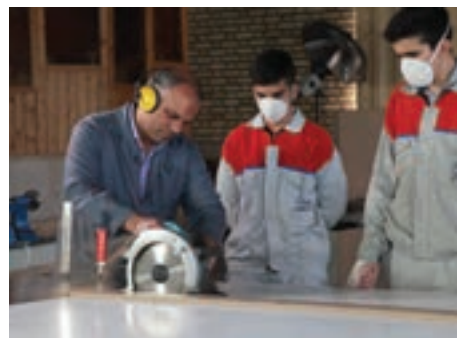
شکل ۲۰- عملیات برش کاری با دستگاه اره گرد دستی برقی
