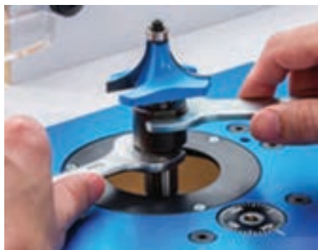
شکل ۱۲۴ - قرار دادن تیغه در کولت و محکم کردن آن با آچار
