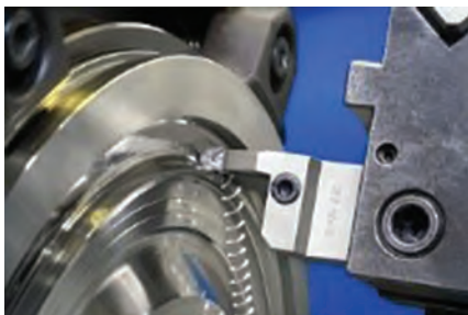
شکل ۴-۶: براده‌برداری به‌وسیله تیغه کاربیدی
