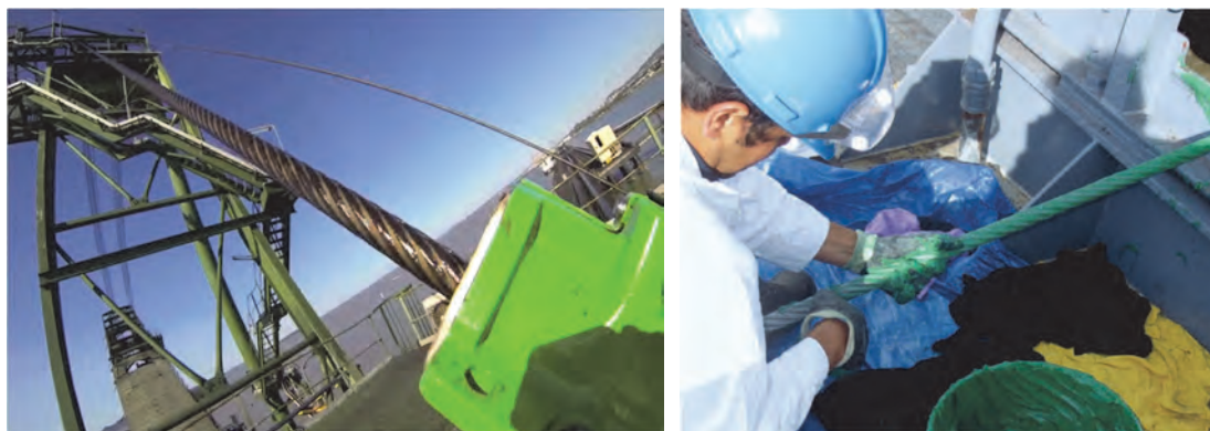
شکل ۲۲-۱ روان کاری طناب سیمی با گریس
