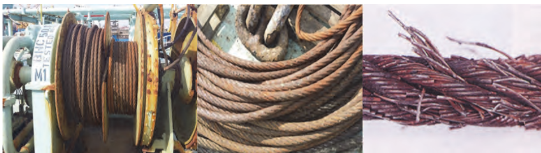
شکل ۱۶-۱ نمونه‌هایی از عدم نگهداری صحیح ماشین‌آلات
