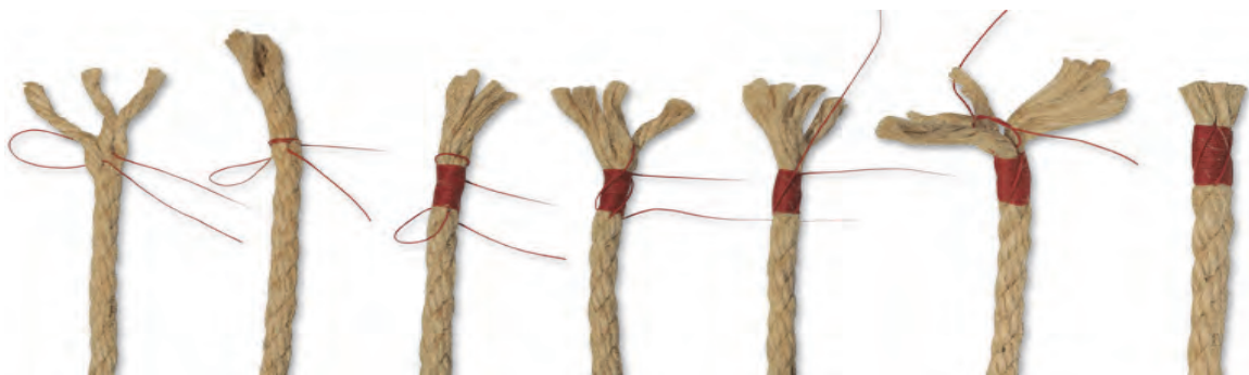
شکل ۲۱-۲- نخ‌پیچی کردن انتهای طناب
