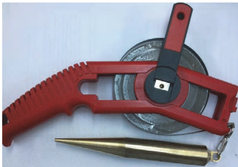
شکل ۳-۶- Sounding tape برای اندازه‌گیری سطح مخزن
