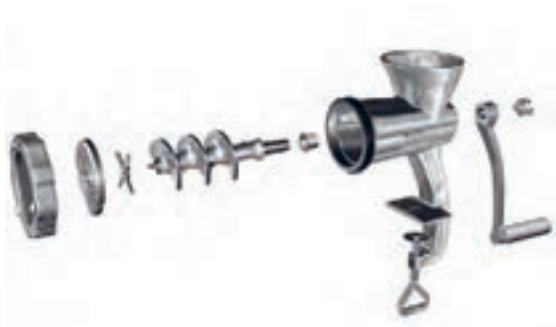
شکل ۶۷- تصویر سه بعدی انفجاری چرخ‌گشت دستی
