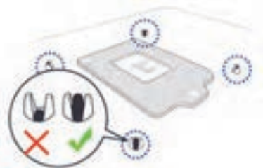
شکل ۳۸- پایه‌های سیستم خنک کننده در پشت برد اصلی
