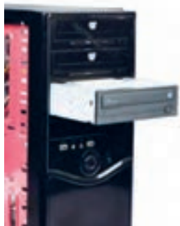
شکل ۵۰- قراردادن دیسک گردان نوری در کیس
