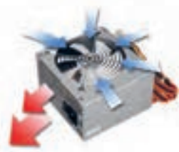
شکل ۲۳- جهت تهویه هوا در منبع تغذیه
