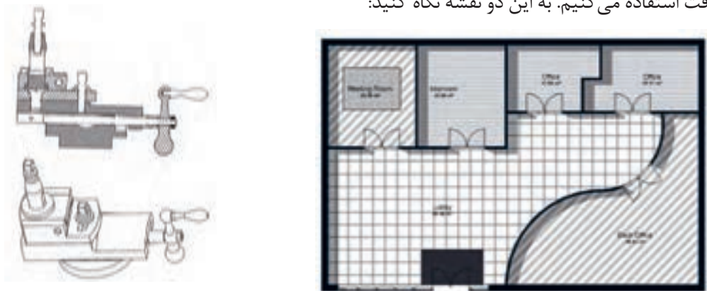
شکل ۱۳- در این نقشه برای تفکیک اتاق‌ها از هاشور استفاده شده است که در ضمن، معرف کفپوش آنها نیز هست. شکل ۱۴- در این نقشه برای تفکیک قطعات در حالت برش خورده از هاشور استفاده شده است.
