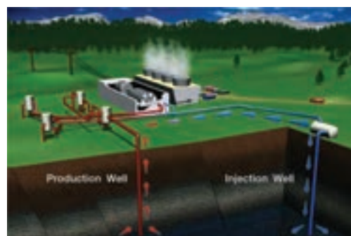
شکل ۱۹ - ۶ نیروگاه زمین گرمایی
