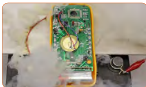
شکل ۱۹-۴ - دستگاه در اثر عدم رعایت نکات ایمنی آسیب دیده است.
