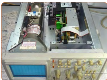
شکل ۴۰-۳- ساختمان داخلی یک نوع اسیلوسکوپ
